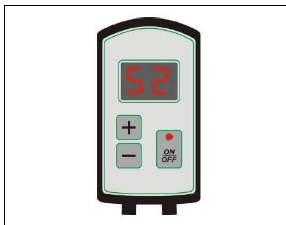
Rys.48 STEROWNIK ELEKTRYCZNY - WIDOK
